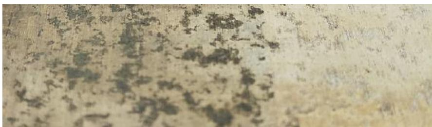
*Рис. 4 – Внешний вид образца алюминиевого сплава до и после обработки пастой ВИП-А*
