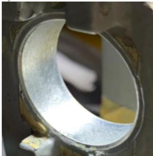
*Рис. 3 – Внешний вид стальной втулки до восстановления цинкового покрытия (а) и после его восстановления (б)*
