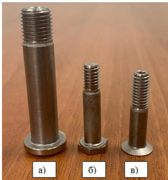
*Рис. 2 – Внешний вид болтов из сплава ВТ47, изготовленных в промышленных условиях АО «Нормаль»: а) болты с плоско-скругленной головкой и короткой резьбовой частью типа Hi-Lok M10; б) болты с уменьшенной шестигранной головкой для соединений со специальной переходной посадкой М6; в) болты с потайной головкой с углом 120 градусов типа Hi-Lok М6*
