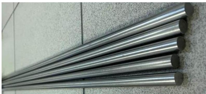
*Рис. 1 – Внешний вид прутков из псевдо-β титанового сплава BT47 производства АО «ЧМЗ»*
