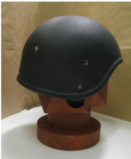
*Рис. 4 – Защитный шлем с корпусом из опытного сплава с  $\beta$ -структурой*
