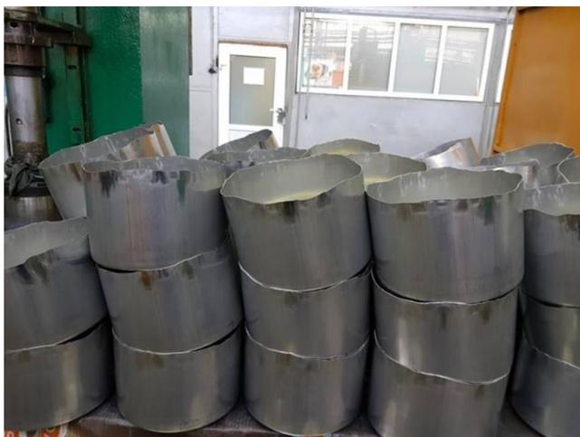
*Рис. 2 – Заготовки после вытяжки*
