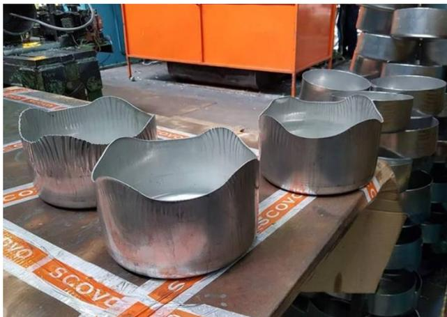
*Рис. 1 – Заготовки после вытяжки с образованием дефектов*
