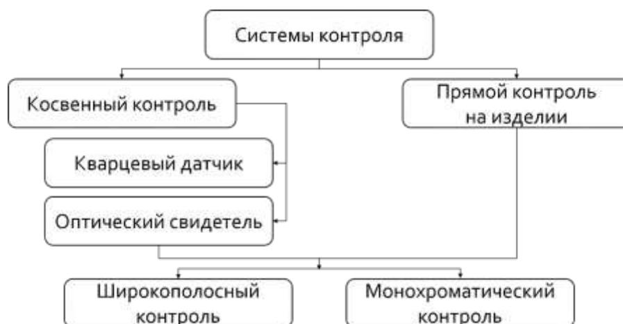
Рис. 1 – современная классификация систем контроля толщины оптических покрытий
