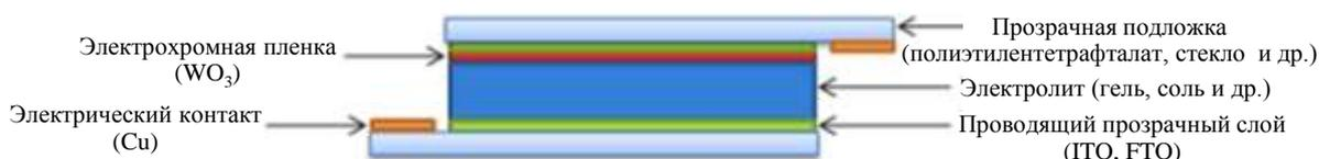
Рис. 1 – Принципиальная схема электрохромной ячейки
