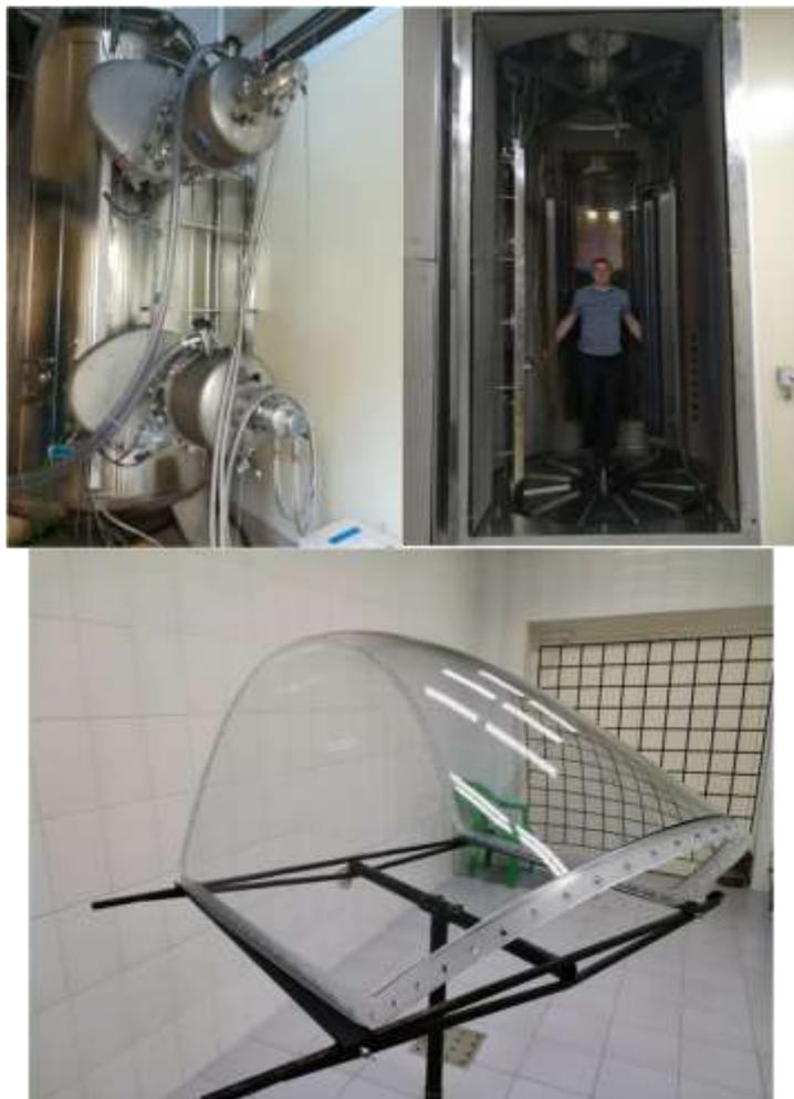
Рис. 1 – Установка для нанесения покрытий на изделия авиационного остекления и часть фонаря самолета Т-50
