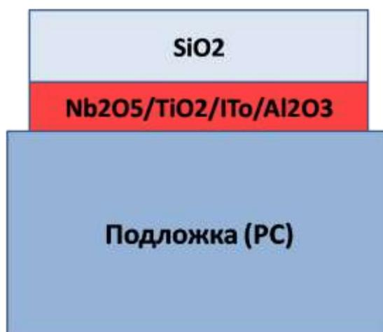
Рис. 2 – Структура двухслойного защитного покрытия
