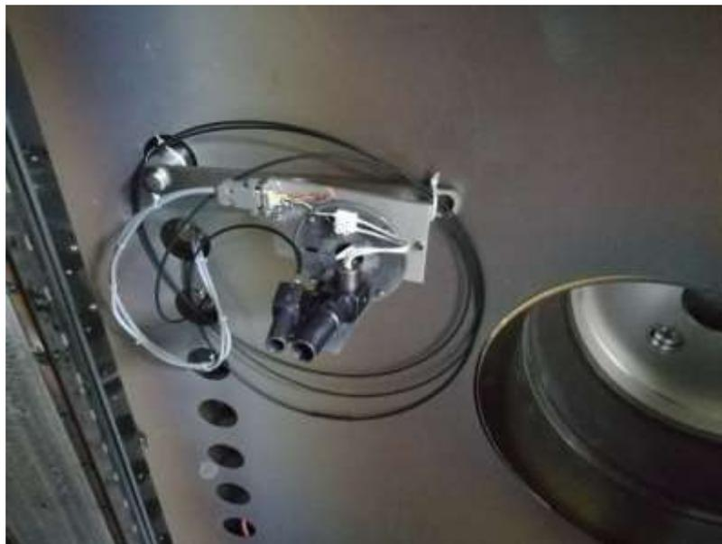
Рис. 9 – Реализация системы прямого контроля, работающей на отражение
