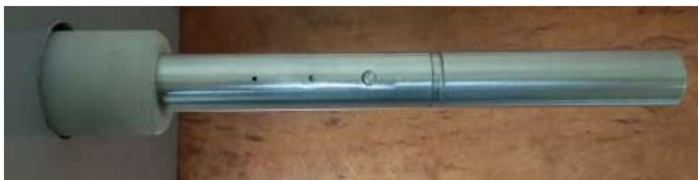
(б) фото калибровочной трубки
