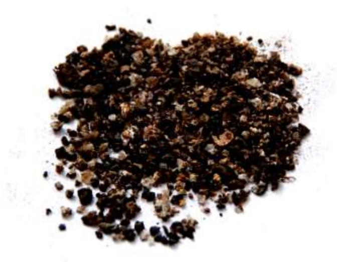
Рис. 3 – Внешний вид смеси отвержденных смол (ЭД-22+КДА) после биоразложения
