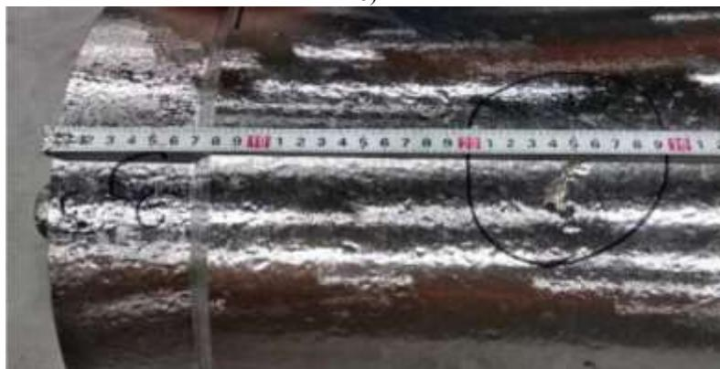
Рис. 2 – Обнаружение дефекта в слитке титанового сплава ВТ22 после ультразвуковой дефектоскопии и механической обработки слитка: а – схема поиска координат в линейном объекте методом акустической эмиссии, б – обнаруженный дефект в слитке титанового сплава ВТ22
