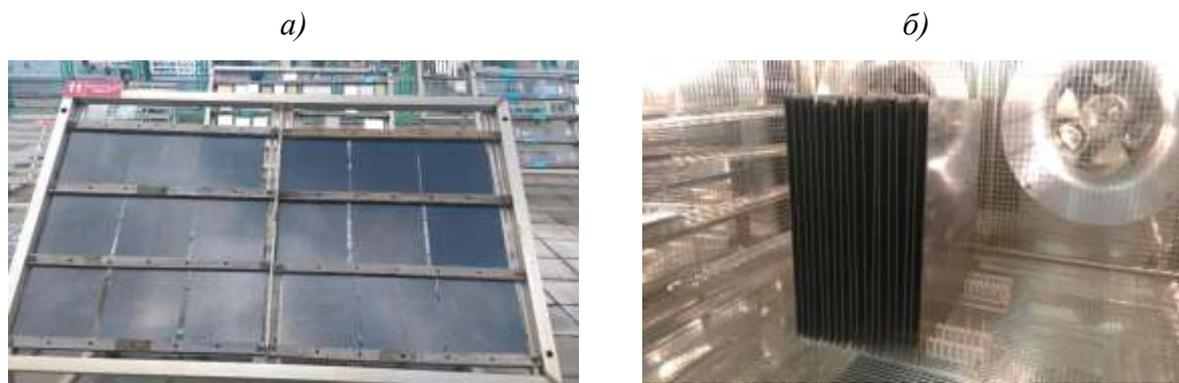
Рис. 1 – внешний вид стенов для натурной экспозиции плит углепластиков в условиях умеренно-холодного климата (а) и рабочего пространства камеры для проведения термоциклирования (б)
