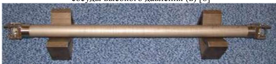
Рис. 4 – Деталь робота манипулятора из МКМ на основе титанового сплава [8]
