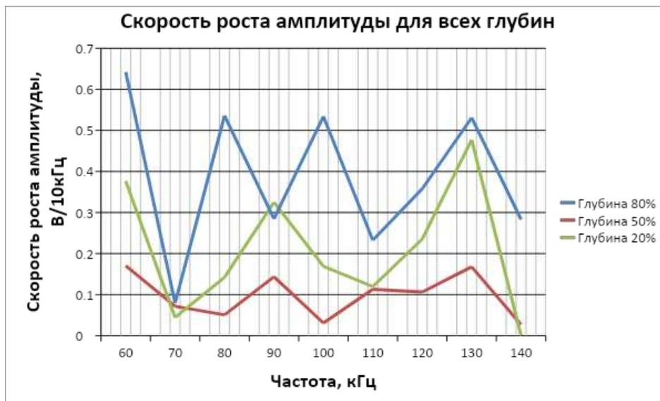
Рис.4 – График зависимости изменения амплитуды сигнала от калибровочных дефектов от частоты
