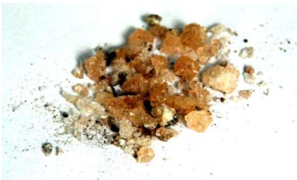
Рис.. 1 – Внешний вид смолы ЭД-22 после отверждения  $H_3PO_4$
