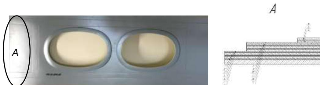
Рис. 5 – Фрагмент обшивки нижней панели крыла из слоистого материала
