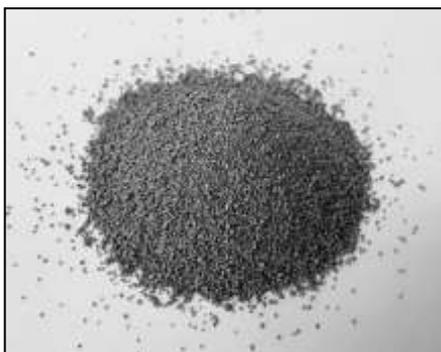
Рис. 1 – Гранулы дисперсно-упрочненного металлического композиционного материала на основе алюминиевого сплава, полученные механическим легированием
