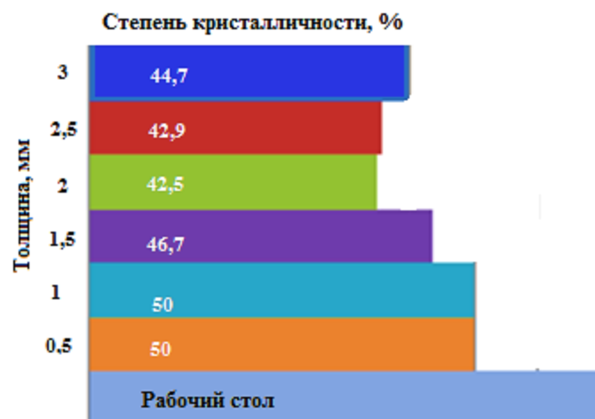
Рис. 4 – Распределение степени кристалличности материала по сечению образца
