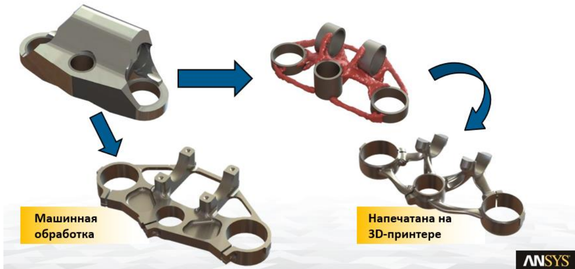
Рис. 2 – Разница между машинной обработкой и аддитивными технологиями
