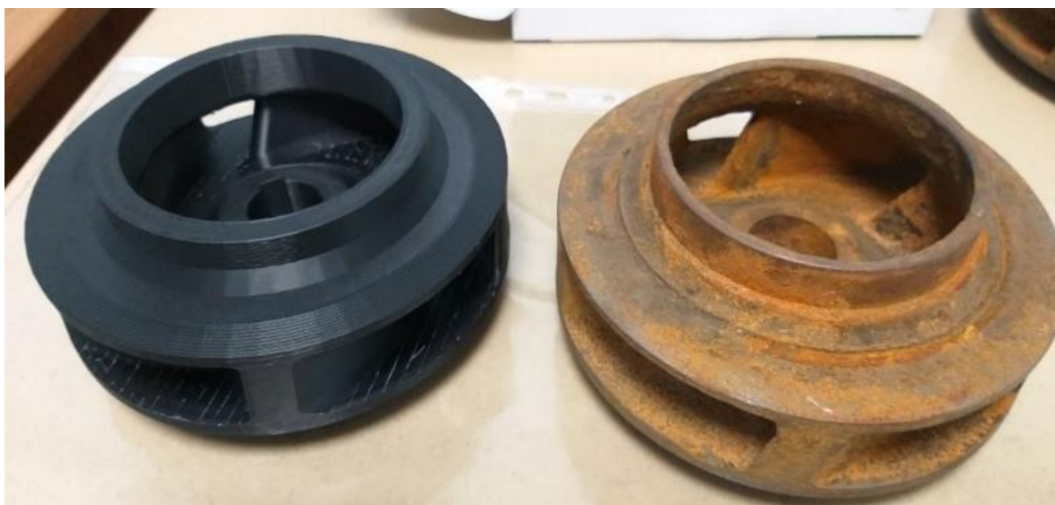
Рис. 2 – Форсунки АВО (выполненная 3D-моделированием – слева, оригинальная – справа)
