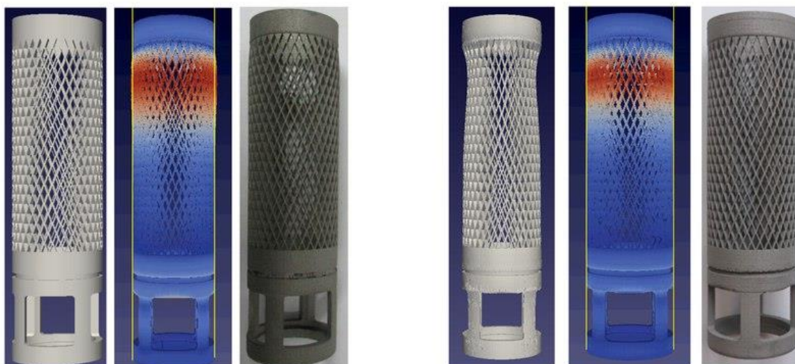
Рис. 6 —Учет компенсации. Оригинальная геометрия (слева) и с компенсацией (справа)
