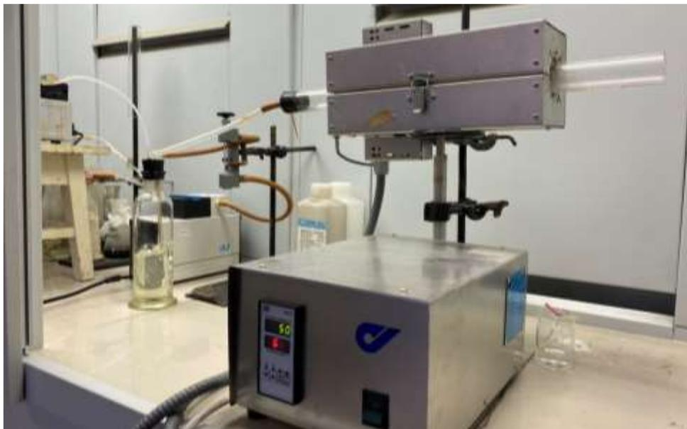
Рисунок 3 – Внешний вид лабораторной установки для изучения газовой коррозии
