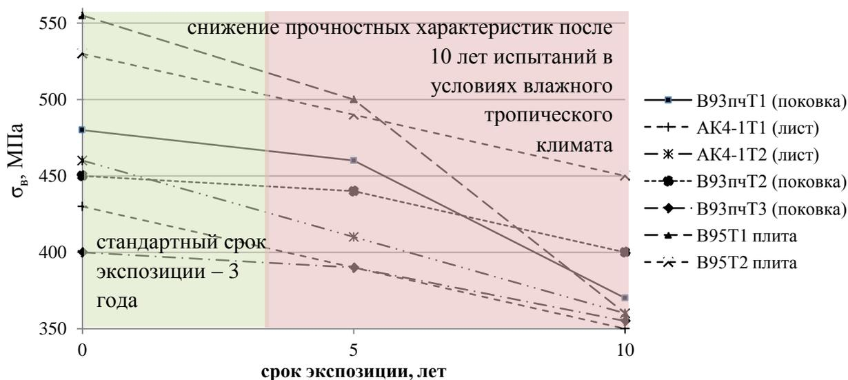
Рисунок 1 – Изменение прочностных характеристик алюминиевых сплавов после 10 лет натуральных испытаний в Батуми
