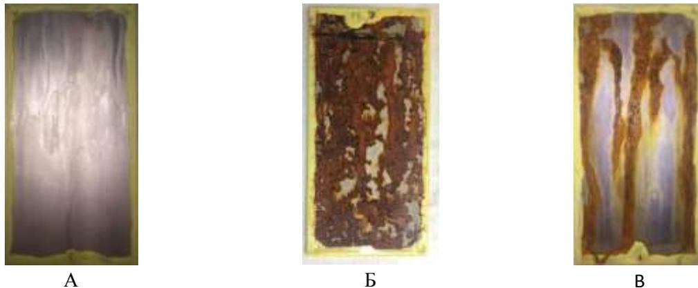
А – исходный образец с покрытием никель-бор; Б – образец после 24 ч в КСТ с толщиной покрытия Ni-B 15 мкм; В – образец после 24 ч в КСТ с толщиной покрытия Ni-B 50 мкм.
