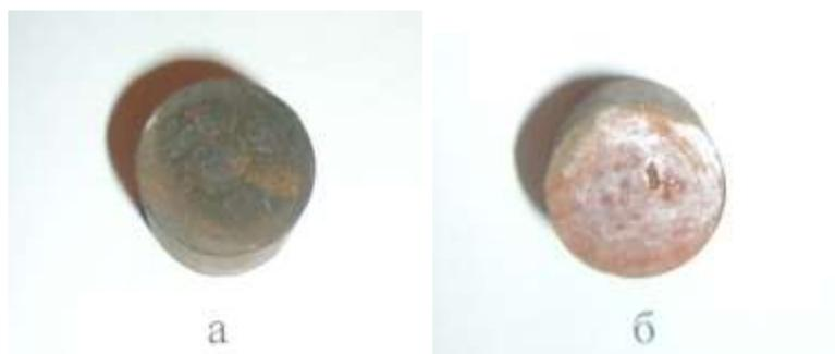
а – без обработки; б – обработка пульсирующим воздушным потоком
