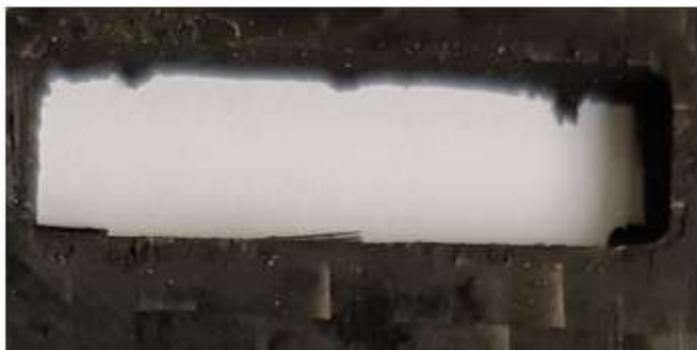
Рис. 3 – Поверхность ВКУ-29 после ЭЭО медным ЭИ на режиме мед
