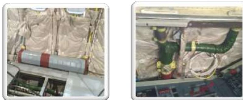
Рис. 5 – Установленные элементы СКВ из ПКМ на ЛА
