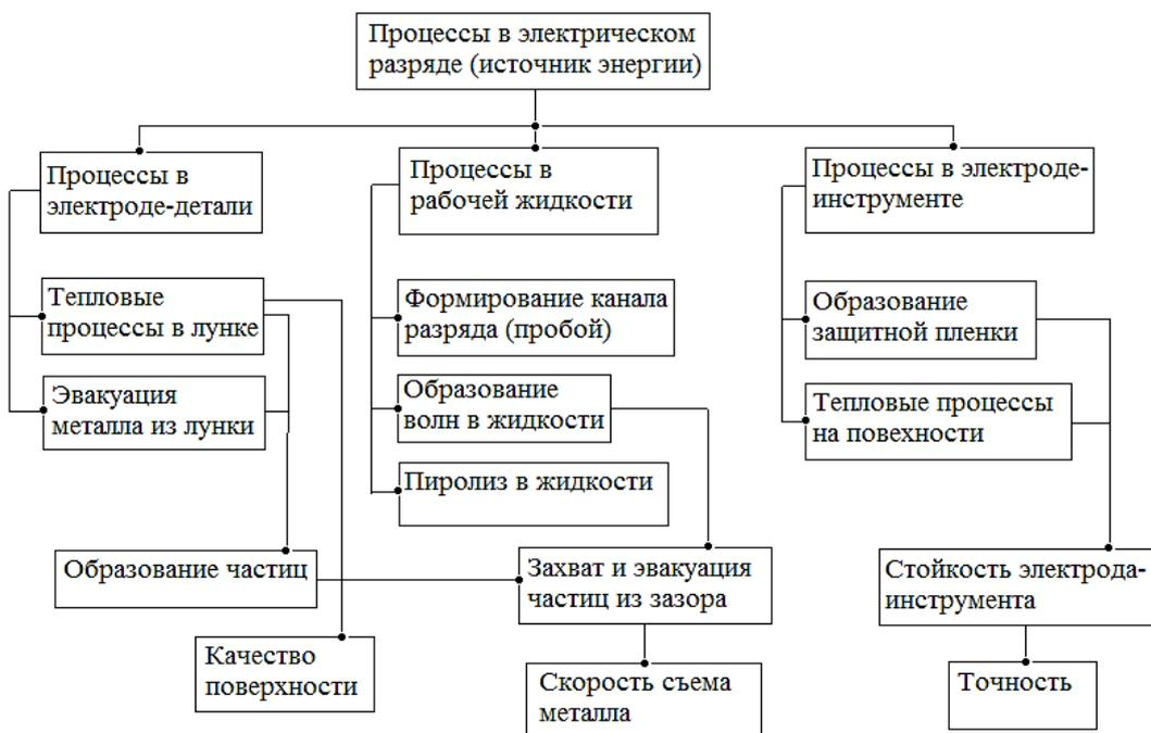
Рис. 2 – Взаимосвязь основных физических процессов при ЭЭО
