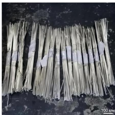
Рис. 5 – Готовая присадочная проволока (диаметр 4 мм)
