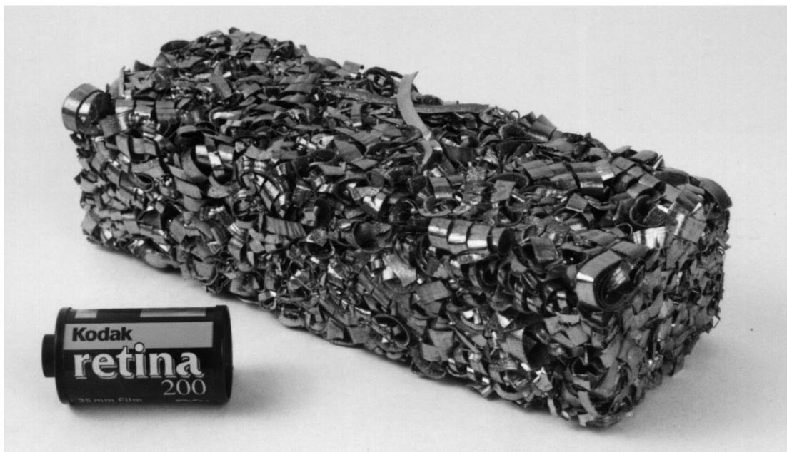
Рис. 3 – Фотография пробного брикета полученного на опытной установке. Стружка титанового сплава 3М. Размер брикета: 175×64×50 мм; плотность 1,1 г/см<sup>3</sup> (пористость 75%); масса 590 г
