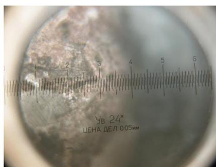
Рис. 3 – Микрофотографии магния и порошкообразной соли  $KCl-NaCl-CaCl_2-MgCl_2-CaF_2-NdF_3$  при 24×кратном увеличении
