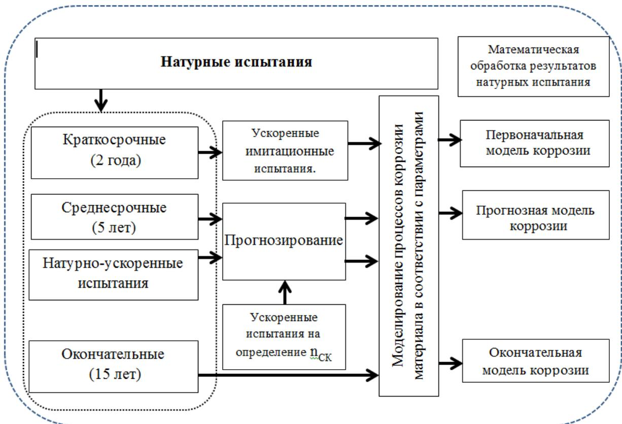
Рис. 1 – Схема проведения комплексных коррозионных испытаний [10]
